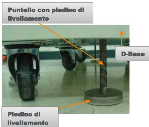
2. Completare il processo di livellamento centrando l'occhiello di livellamento all'interno del vano porta-attrezzi sulla superficie superiore della D-Base (Figura 7). Utilizzare i piedini di livellamento per eseguire le regolazioni fini.
