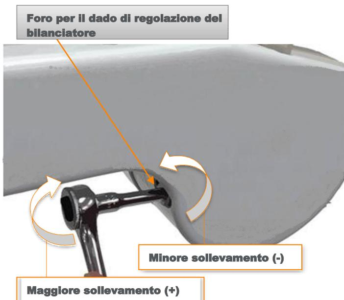
1. Con la protezione piombata per il corpo assicurata al cavo del bilanciatore, abbassare lo schermo di 15 - 20 cm (6 - 8") e rilasciarlo per controllare il bilanciamento. Se la protezione piombata per il corpo rimane in posizione, non è necessaria alcuna ulteriore azione.
