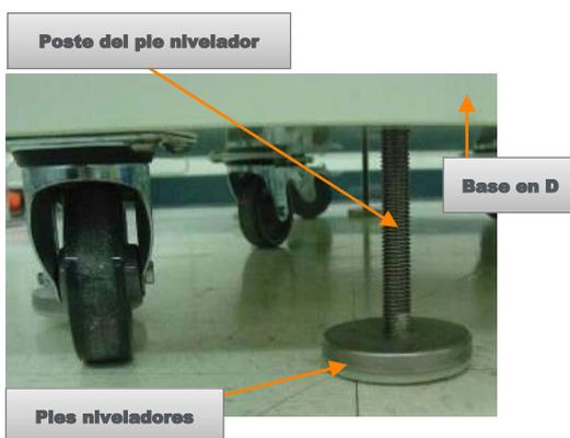
2. Finalice el proceso de nivelado centrando la burbuja de nivelado dentro de la caja de herramientas en la superficie superior de la base en D (figura 7). Utilice los pies niveladores para realizar pequeños ajustes.
