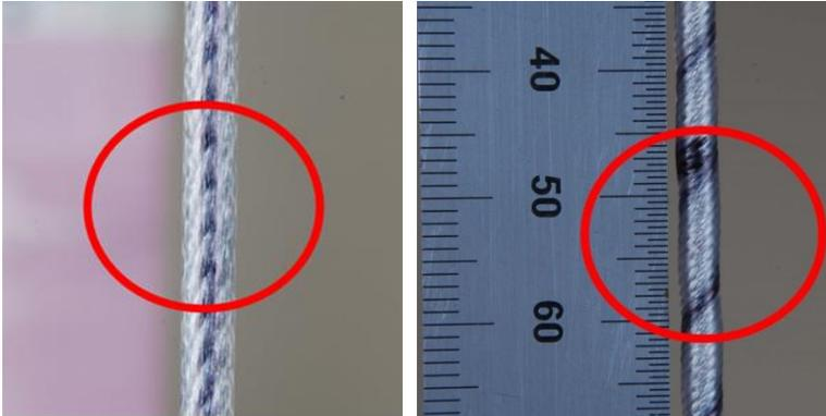
Abbildung 4: Beschädigtes Kabel (Grübchen und Blase)
