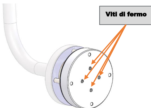
Figura 29: Punto di collegamento dello schermo ZGCMRS
