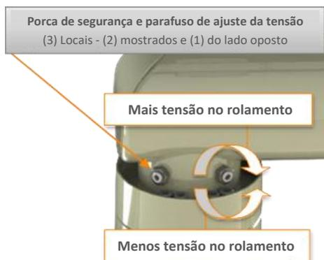
4. Aplique o teste de força de compressão na montagem da lança na tampa da chave de fim de curso mais distante do pivô. A força deve estar entre 1,4 e 1,8 kg (3 e 4 libras) de resistência (Figura 28).
