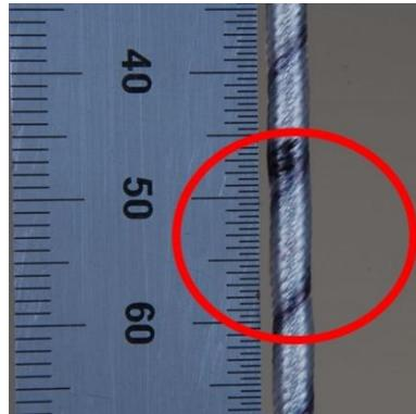
Figura 4: cabo danificado (ondulação e bolha)
