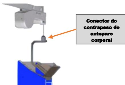
Conector do anteparo corporal sem o componente giratório (Figura 46: Sem o componente giratório):
