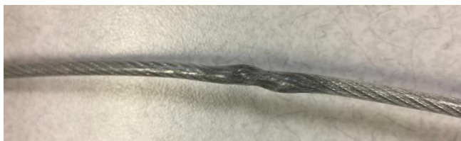
Rysunek 5: Linka uszkodzona
